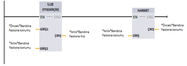
Şekil 5.'te gösterilmiştir, ilk kısımda konum farkı ile 10ms için hızı belirliyor ve hafızaya alıyor. PLC
