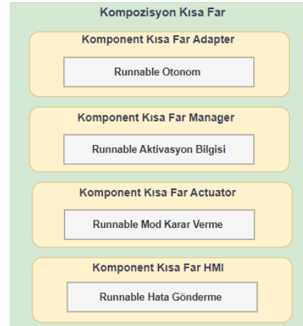
Şekil 2. Kısa far mimarisi içerisindeki yapılar.
