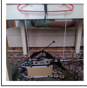
Şekil 3: Y – ekseninde eylemsizlik momenti için kurulan deney.
