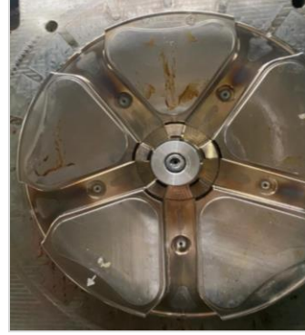
Şekil 8: Plastik enjeksiyon kalıbının dışına alüminyum göbeğin yerleştirilmesi.
