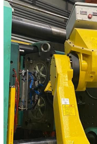
Şekil 9: Enjeksiyon kalıbının erkeklerinden alüminyum göbekli plastik kasnağın alınması.
