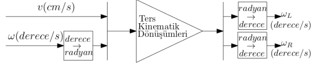
Şekil 7: Sinyal üretici, ters kinematik ve diğer bloklar
