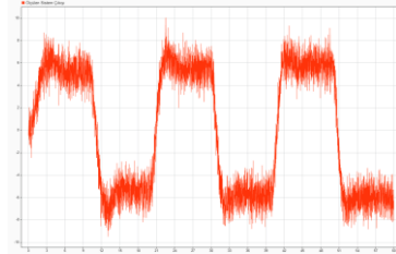
Şekil 6: Modelin zamanla değiştiği durumda sistem çıkışı (ölçme gürültüsü olduğu durum).
