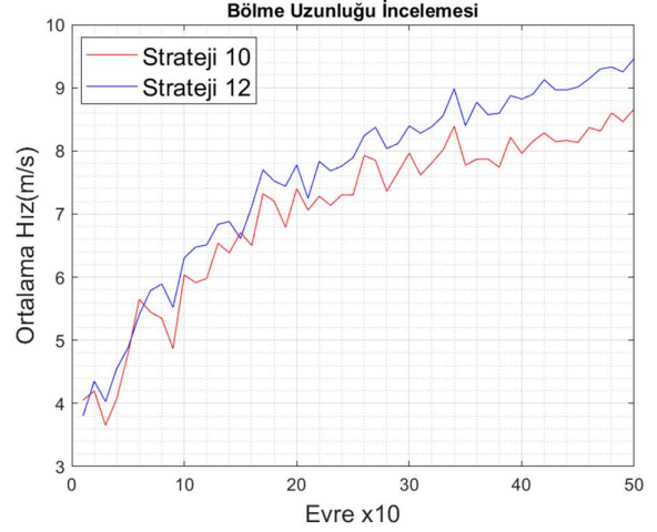
Şekil 5: Diğ er parametreler sabitken bölme uzunluđu parametresinin karşılařtırılması
